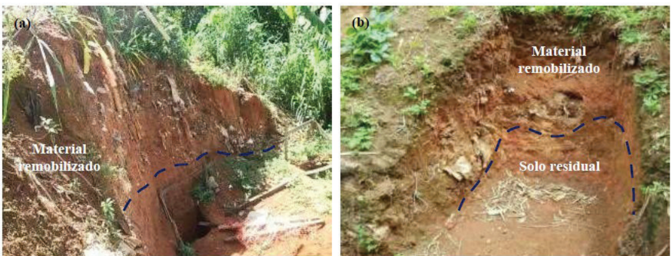
Fig. 7.14: Talude de corte ilustrando cobertura de material remobilizado constituído por mistura de solo e lixo, 11-Calabetao (557659mE/8570115mN). Corte em encosta mostrando material remobilizado sobre o manto de alteração, 16-Mamorana
